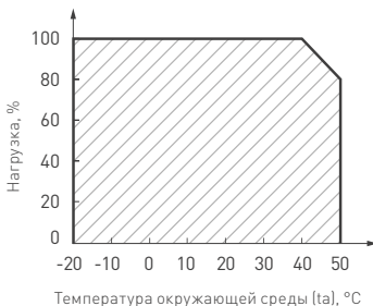
Рис. 2. Максимальная допустимая нагрузка, % от мощности источника.
